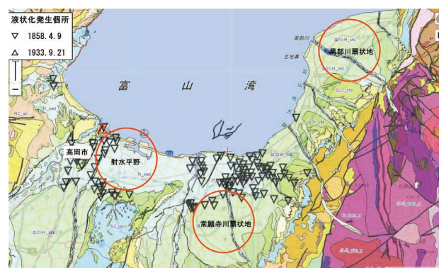
図-9 液状化発生箇所 4)
