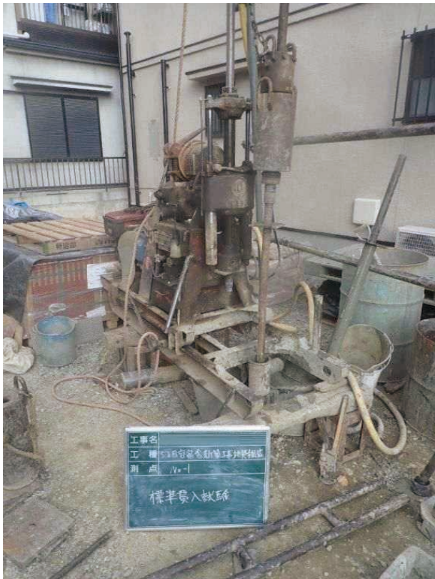
写真-3 ロータリー式ボーリングマシンによる標準貫入試験現場
