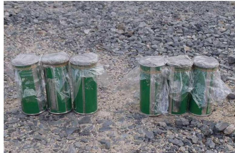
写 一軸圧縮試験供試体
