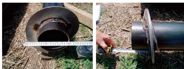
写真-6 小口径鋼管杭 3)
