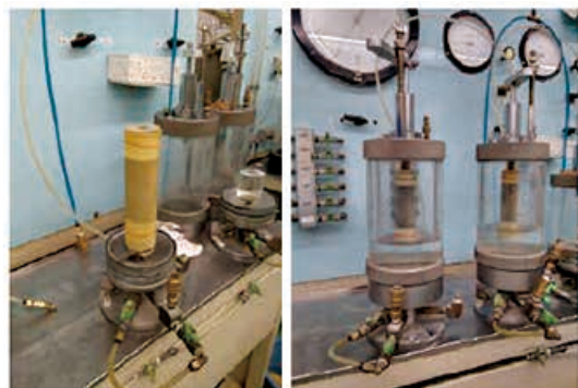
写真-4 室内土質試験状況（一軸・三軸圧縮強度試験） 3)
