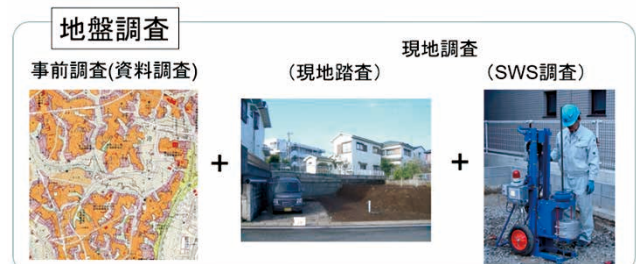
図-6 地盤調査の基本プロセス
