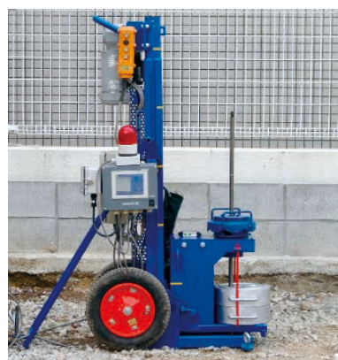
写真-2 全自動スクリーウエイト貫入試験機（TW-1000）
