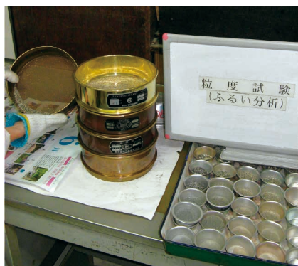
写真-3 室内土質試験状況（粒度試験） 2)
