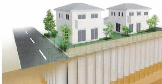
図-6 格子状地盤改良工法<sup>6)</sup>
