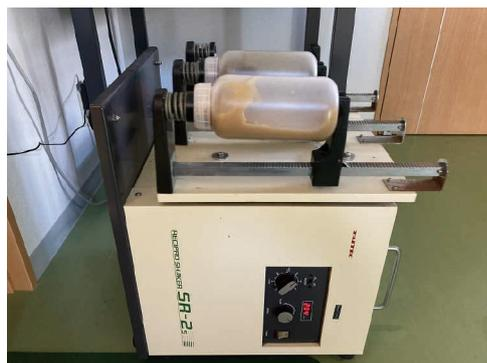
写真-2 環境庁告示第46号溶出試験状況
