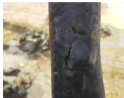
ホースの破損によるセメントスラリーの飛散
