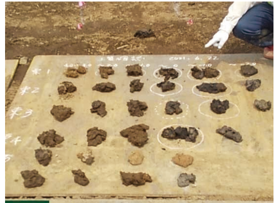
写真-3 施工前に実施した土質サンプル：(地盤改良機ロッド先端に装着したスクリーオーガーで採取)
