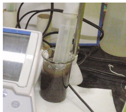
写真-2 試料液のpH測定
