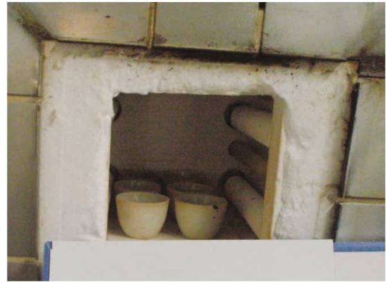
写真-7 電気マッフル炉での試料加熱
