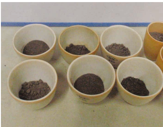
写真-6 るつぼにいった炉乾燥試料
