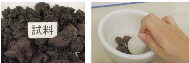
写真-5 空気乾燥した土と乳鉢でのときほぐし
