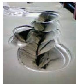
写真-16 液状化による噴砂
