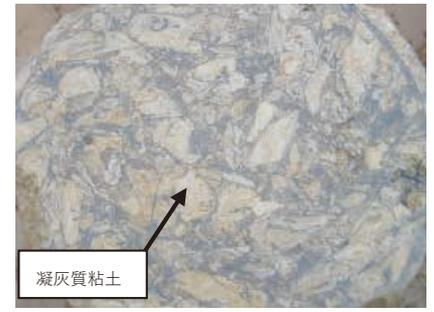
写真-10 セメント安定処理工法の切断面、攪拌効率が良くない
