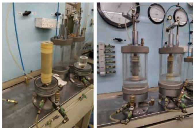
写真-2 供試体の設置(左)・圧力室給水状況(右)
