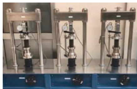
写真-1 一軸圧縮試験状況<sup>1)</sup>
