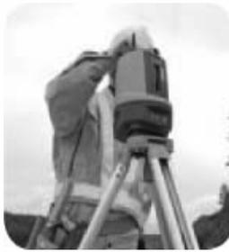
①見た目平らに三脚を置けばあとは器械が自動整準！簡単に杭ナビの設置完了！
