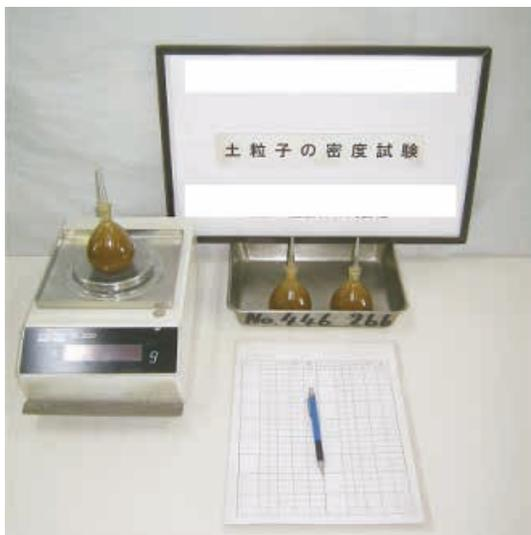
写真-1 土粒子の密度試験状況
