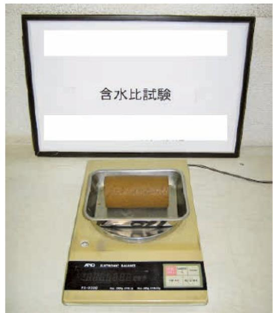
写真-2 含水比試験の試験状況
