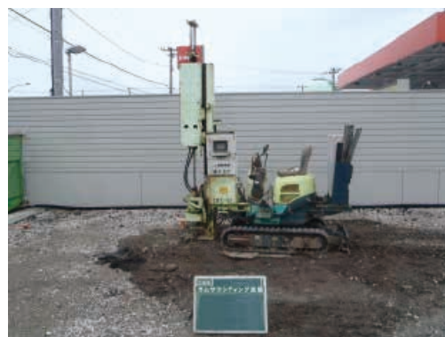
写真-1 大型動的コーン貫入試験の概況（全自動） （オートマチックラムサウンディング）
