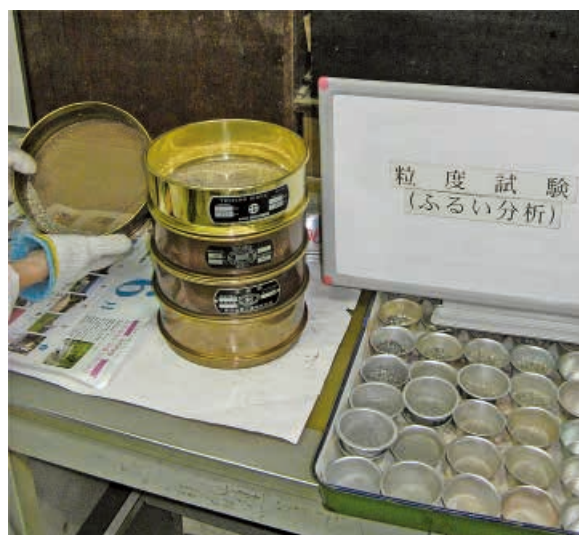
写真-1 室内土質試験状況（粒度試験） 1)
