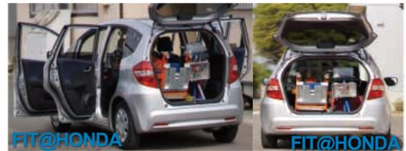
写真-2 μRS 仕様の PDC の車載状況
