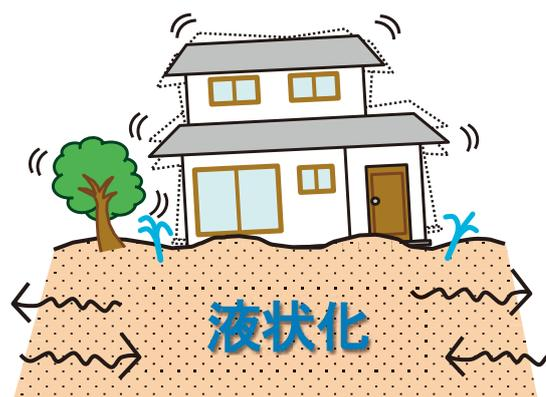
図-1 液状化現象で被災した戸建住宅のイメージ
