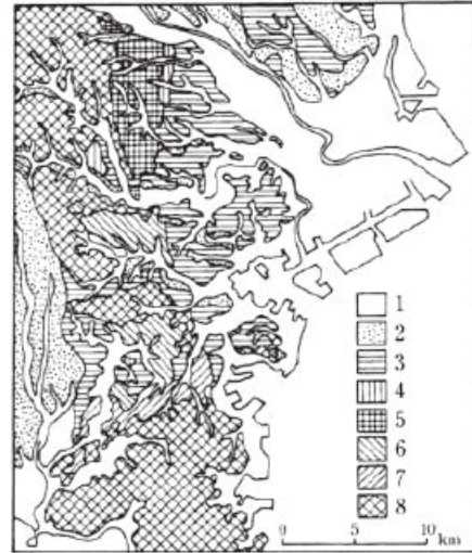
1：沖積層・盛土 2：小原台砂礫層以降の堆積物 3：下末吉層 4：土橋層・鶴見層 5：オシ沼砂礫層 6：上倉田層 7：屏風ヶ浦層-長沼層 8：基盤（上総層群）
