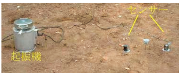
図-1 表面波探査機（起振機方式）
