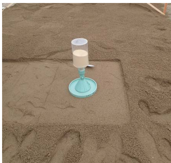
写真-2.3 現場密度試験の様子
