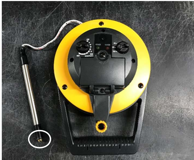
写真-2.5 水位計(計測部は○で示す箇所)
