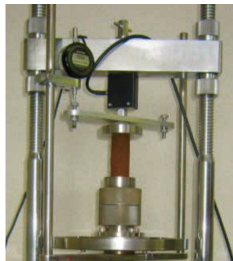
写真-3 一軸圧縮試験状況
