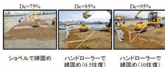
写真1 試験盛土の作成状況および手順 （一財）建設工学研究所提供
