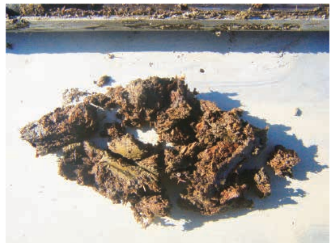
写真-4 採取土 腐植物を多く混じるシルト
