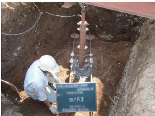
写真-1 平板載荷試験状況
