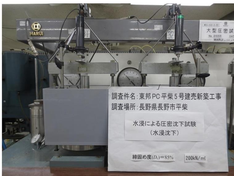
写真 4-1  $D_c=85\%$ 、 $200\text{kPa}$ 、水浸沈下試験の様子(下から注水)
