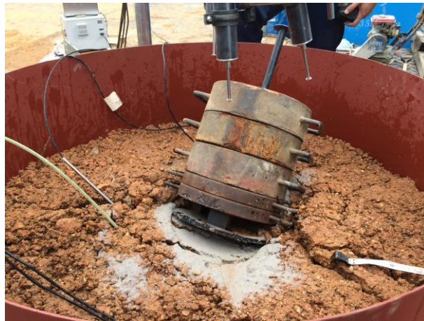
図-3.24 緩詰め盛土の地盤崩壊の様子
