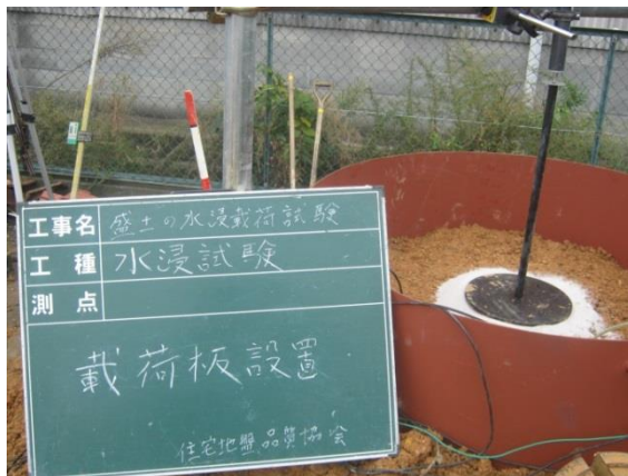
図-3.17 載荷板設置状況
