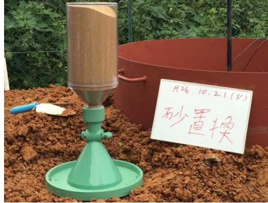
図-3.19 砂置換法の試験概況
