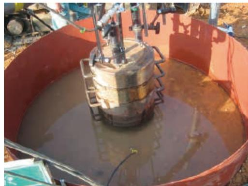
試験盛土での水浸荷重実験
