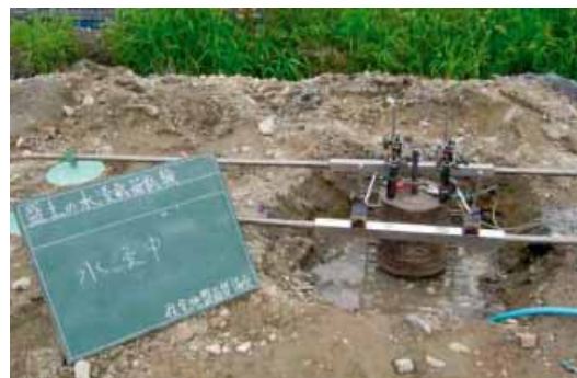
現場水浸沈下試験状況
