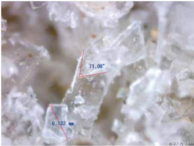
写真-2 microscope, × 500, シラス
