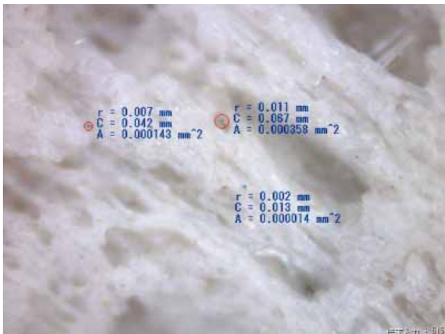
写真-3 microscope, × 500, 軽石 (写真提供: 兼松日産農林株) 水谷氏
