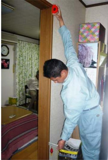
写真 1-1 下げ振りによる測定
