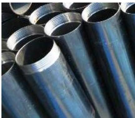
写真 3-1-11 ネジ加工の例
