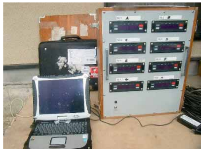
写真-5 変位置監視装置
