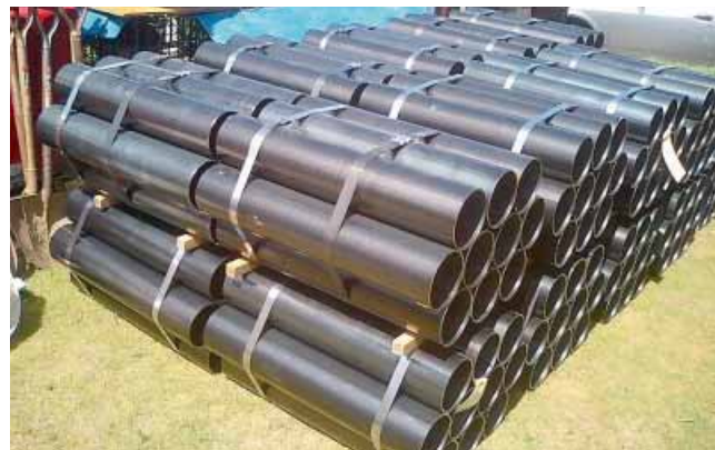
写真-1 鋼管材φ165.2mm t=4.5mm L=700mm 加工
