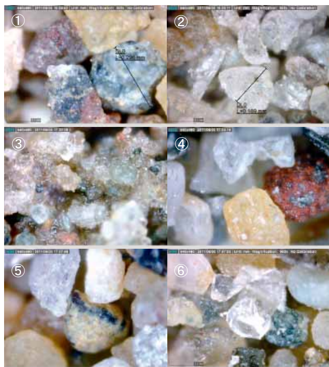
写真-3 東日本大震災の液状化で噴砂したサンプル
