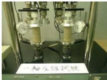
写真-4 一軸圧縮試験状況
