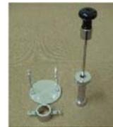
写真-1 一軸圧縮試験用モールド
