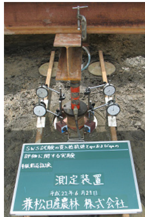
写真-2 平板载荷試験
