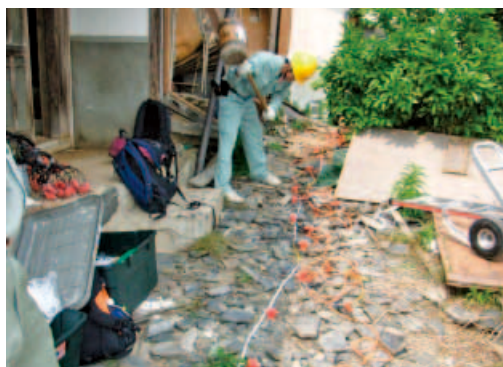
写真-9 表面波探査の試験状況
