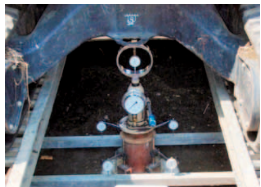
写真-5 平板载荷試験の測定装置
