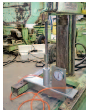
写真-10 ジョカルテⅡの荷重確認状況
