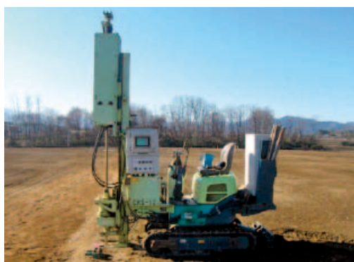
写真-8 オートマチックラムサウンディング試験機
